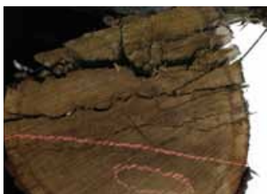
Sprickor orsakade av att maskinen trycker på trädet vid fällning.
