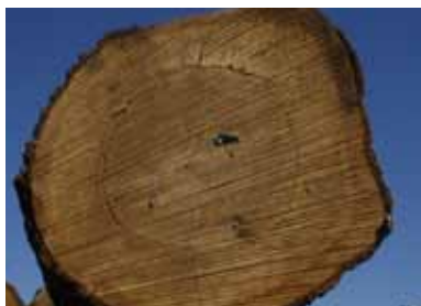
Ringsprickor syns ibland dåligt direkt efter avverkning.
