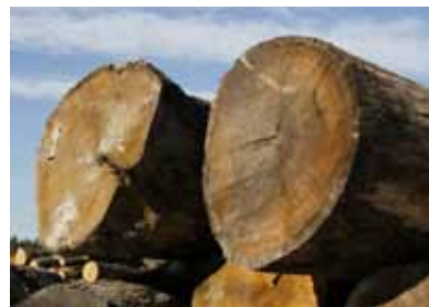
Torrstock. Diametern sätts ner med splinten.
