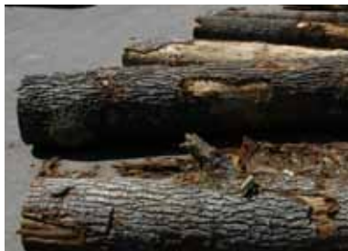
En fin A-stock som vrakats på grund av dålig kvistning.
