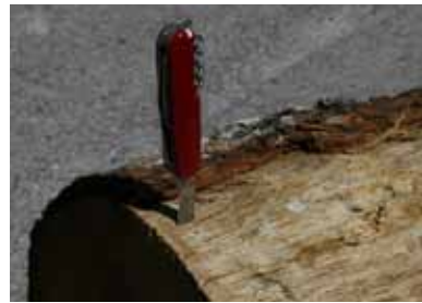
Hög barkningsgrad ger ojämn uttorkning med sprickor som följd.
