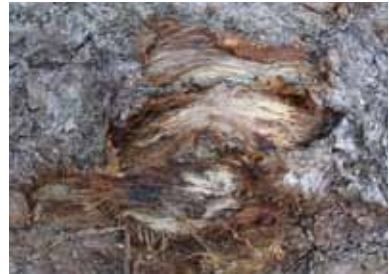
Övervallad kvistbula som sticker ut mindre än 50 mm från mantelytan bör inte röras.
