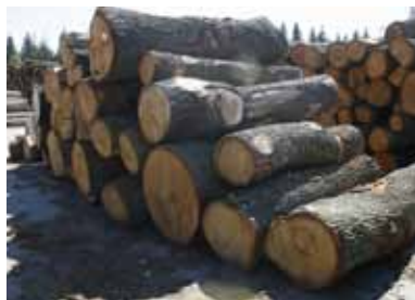
C-stock ek. Summan av fel får minska sågutbytet max 30 procent.
