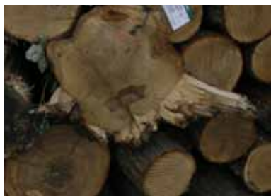
Otillåten fällkam, max 50 mm.
