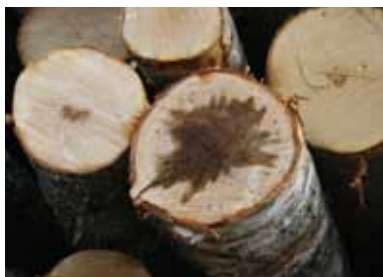
Stjärnformad rödkärna innebär sprickor.
