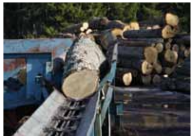
Långböj med en båghöjd på 10 cm är ok om rotten kapas av.
