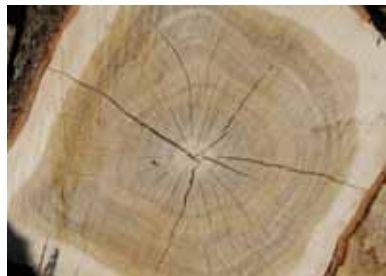
Solsprickor ger ej avdrag. Hög splintandel kan ge diameternedsättning.
