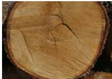
Små sprickor orsakade av solen går sällan djupare än några cm.
