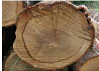
Maskinsprickor i övre tredjedelen.
